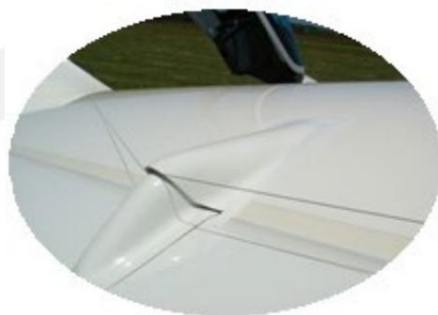
IMAGE 12 : CORDE DE RÉCUPÉRATION COINCÉE SUR LA PELLE D'ATTACHAGE
